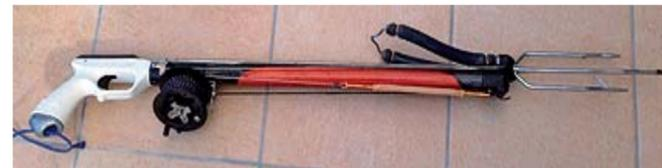
Flèche d'origine remplacée par un trident titane en grande partie de ma fabrication à la suite d'une réparation.
